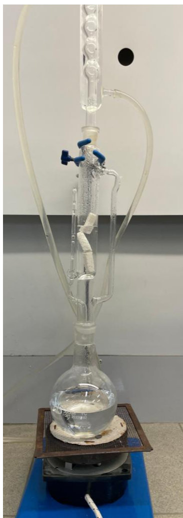
Рисунок 4.2 – Моделирование атмосферных процессов в экстракторе Сокслета
